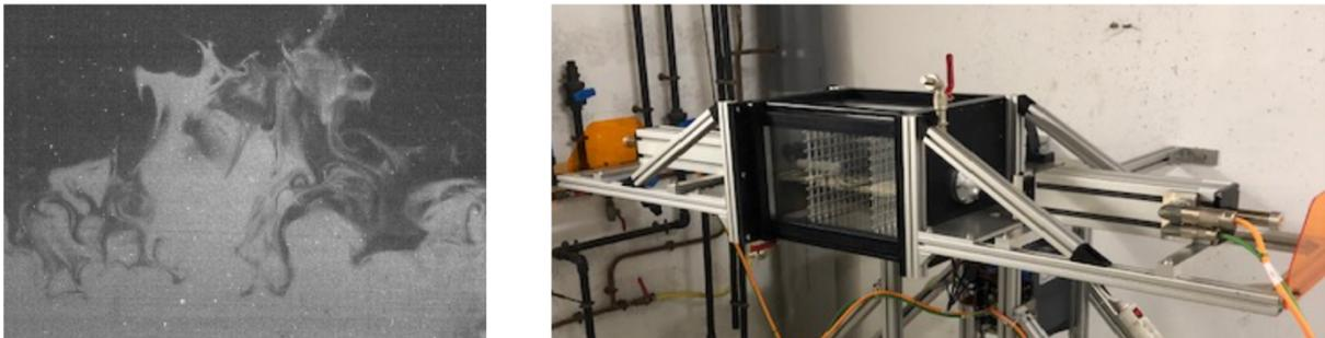
Figure 1 : photographies d'un exemple de front propagatif turbulent (© B. Isnard) et du nouveau dispositif expérimental.
