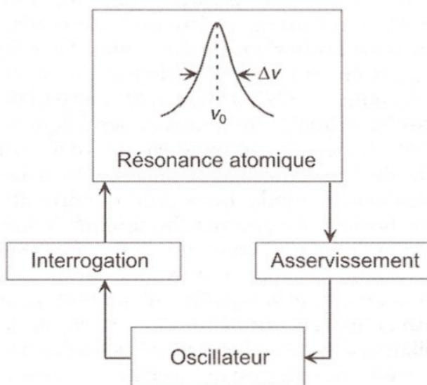
Figure 6 – Principe d'une horloge atomique.
