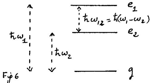
Un atome, initialement excité dans l'état  $e_1$  retourne dans l'état fondamental  $f$  en passant intermédiairement par  $e_2$  et en émettant successivement, 2 photons de fréquences voisines de  $\omega_{12}$  et  $\omega_2$ .
