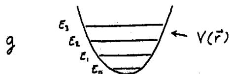
2 niveaux électroniques e et g avec la même structure vibrationnelle associée à la vibration de l'ion dans le potentiel piégeant
