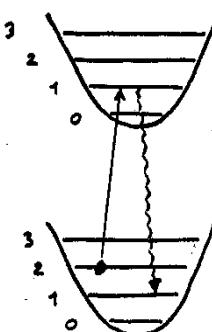
Mécanisme de "luminoréfrigération" suggéré par A. Kastler pour refroidir les degrés de liberté Zeeman ou hyperfins, et appliqué ici directement aux degrés de liberté de vibration (ref. (4))
