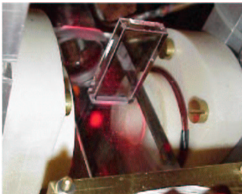
FIG. 4.7 – Piège magnéto-optique. La boule rouge au centre de l'image correspond à un nuage de 10^9 atomes de lithium refroidis à des températures de l'ordre du mK.
