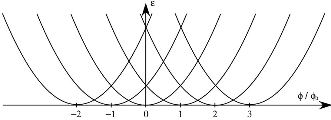
FIG. 2 – Spectre d'énergie de l'anneau conducteur en fonction du flux magnétique.
