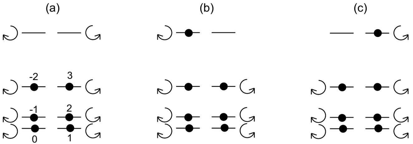
FIG. 3 – Occupation des niveaux d'énergie dans le cas particulier  $\phi = \phi_0/2$ . Le courant résultant est nul si  $N$  est pair (a), et non nul avec un signe fluctuant si  $N$  est impair (b-c).
