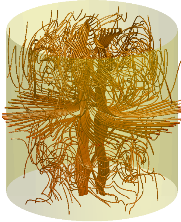
FIG. 3.7: Lignes de force du champ magnétique pour Rm = 75 . Le champ est principalement un quadrupole axial. En plus de la composante axisymétrique, on reconnaît la présence du mode m = 8 près des disques.
