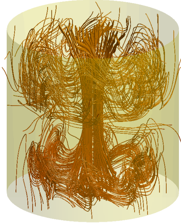
FIG. 3.6: Lignes de champ magnétique pour Rm = 35 . Le champ est principalement un dipole axial. En plus de la composante axisymétrique, on reconnaît la présence du mode m = 8 près des disques.
