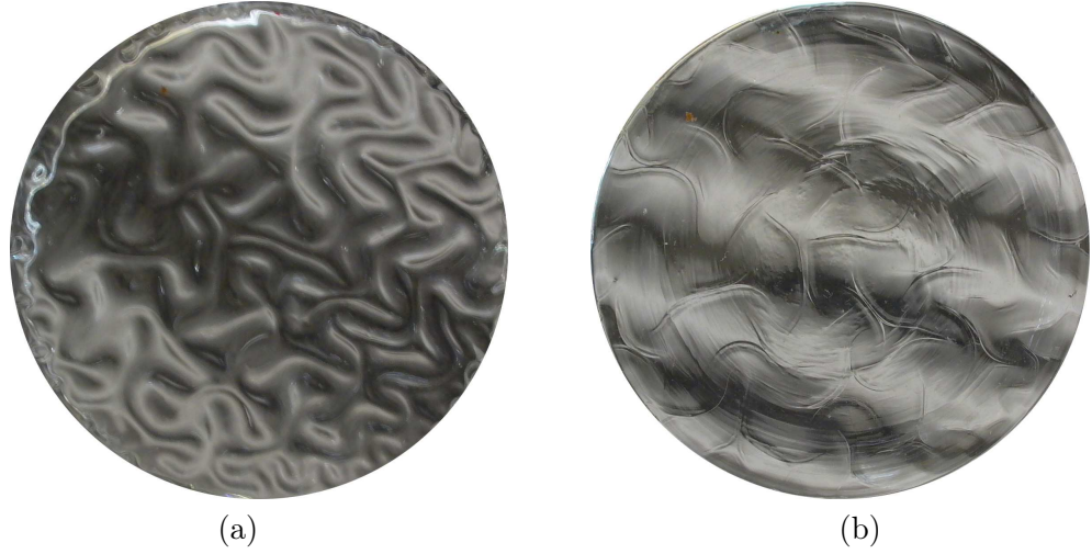
FIG. 9 – Surface d'un bicouche à l'air libre (a) et dans l'eau (b). Une fine couche (1 mm) de gel gonflant (IV) repose sur une couche très épaisse de gel inerte beaucoup plus mou (I), à laquelle elle est liée chimiquement. Alors que la photo (a) exhibe la forme générale des motifs d'instabilité, la photo (b), du fait de la faible différence entre les indices de réfraction du gel et de l'eau, ne laisse apparaître que les lignes de flexion où la contrainte est la plus forte. On utilise en fond des niveaux progressifs de gris pour mieux faire apparaître les motifs.
